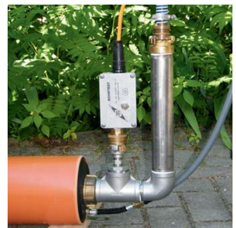
Bild 8 An eine Prüfblase angeschlossener Druck-Messumformer für Dichtheitsprüfungen Verfahren Wasser mit Messung des Prüfdrucks.
