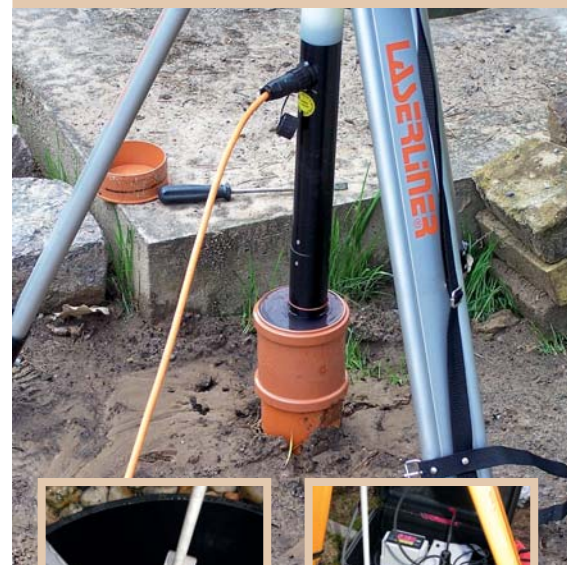
Bild 3 Staurohr als Schauglas mit Zentimeter-Graduierung, (Auflösung 1 mm) zum Ablesen eines Füllstands
