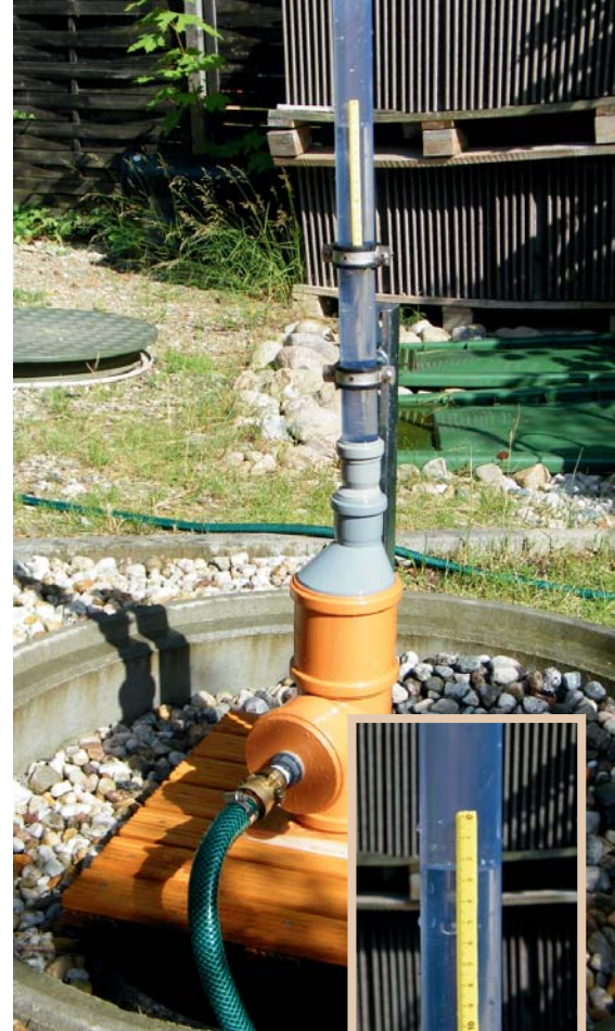
Bild 3 Staurohr als Schauglas mit Zentimeter-Graduierung, (Auflösung 1 mm) zum Ablesen eines Füllstands
