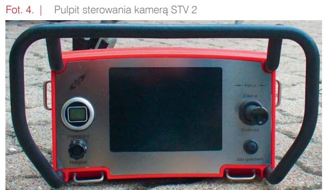
Fot. 4. | Pulpit sterowania kamerą STV 2
