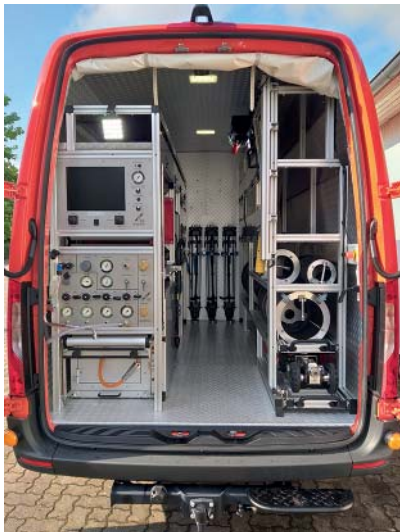
Hätte sich so gut auf dem IFAT-Ausweichtermin im September gemacht: Universal-Dichtheitsprüfer incl. Einzelmuffenprüfung sowohl mit Einzel- als auch Doppeldichtungsprüfgeräten
