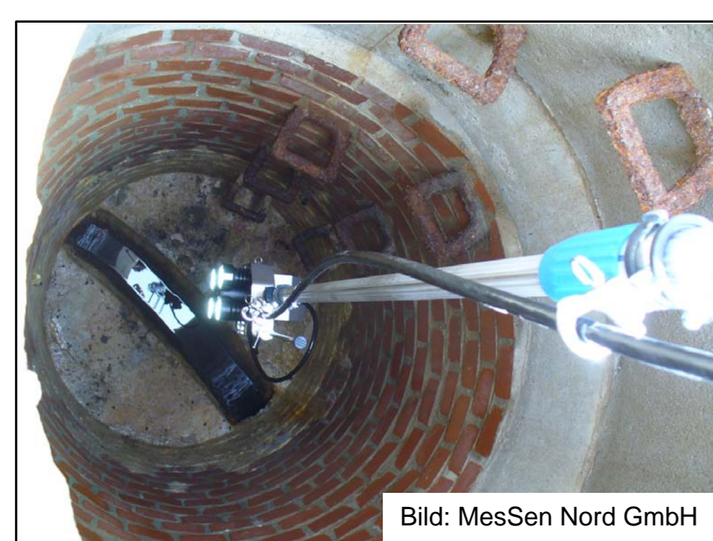
Kombinierte Schacht- und Haltungsinspektion
