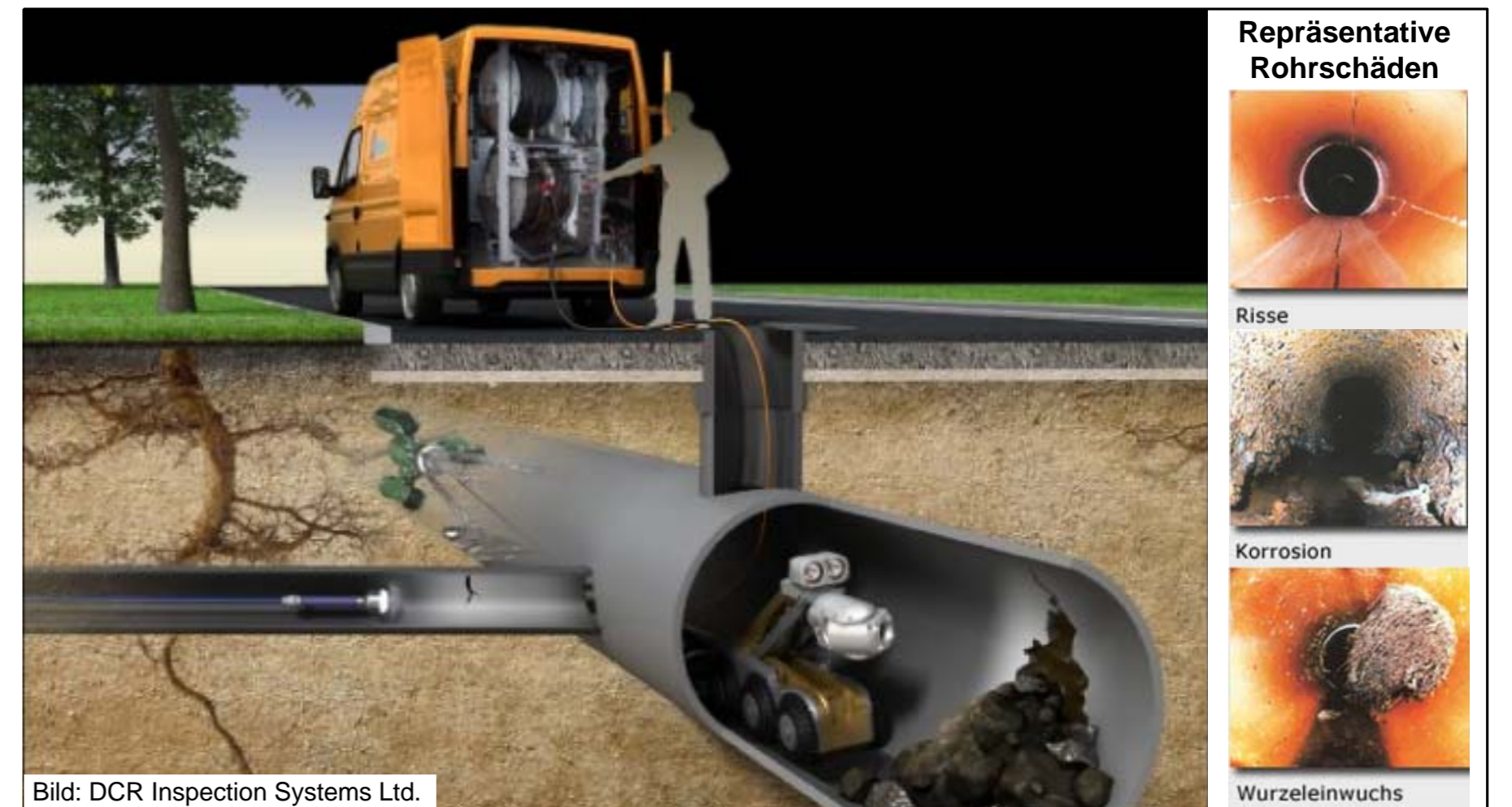
Herkömmliche TV-Inspektion - üblicherweise von Fremdfirmen durchgeführt Rechts: repräsentative Rohrschäden (Quelle: Baier Rohrreinigung GmbH)
