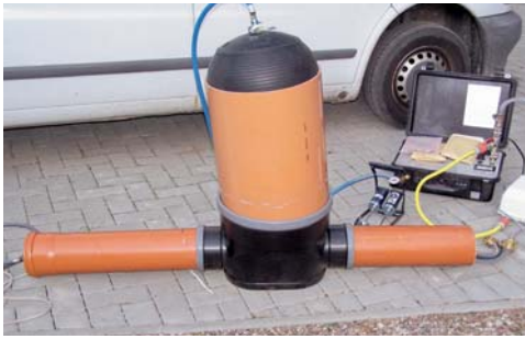
Dichtheitsprüfung eines Inspektionsschachtes mit Luftüberdruck. Bereits bei einem Luftüberdruck von 60 mbar wurden das Steigrohr und die angeschlossenen Rohre aus dem Schachtboden herausgedrückt.
