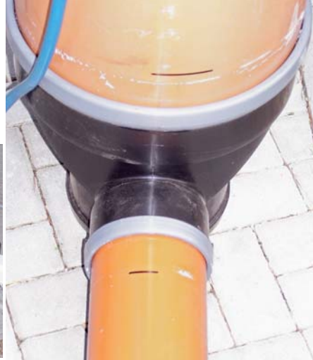
Dichtheitsprüfung eines Inspektionsschachtes mit Luftüberdruck. Bereits bei einem Luftüberdruck von 60 mbar wurden das Steigrohr und die angeschlossenen Rohre aus dem Schachtboden herausgedrückt.
