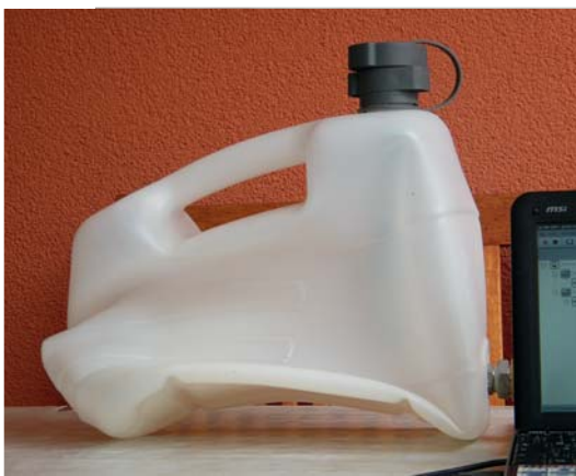
DAS ERGEBNIS: Verformung des Behälters.
