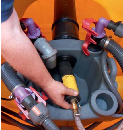
GUTES DESIGN EINER PROBENAHMENVORRICHTUNG: Eine Standard-Sperrblase kann problemlos eingebaut werden. Bild 7
