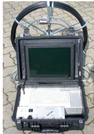
Kamerahaspel 50m mit TFT (IP 65) und automatisch aufrechtem Bild
