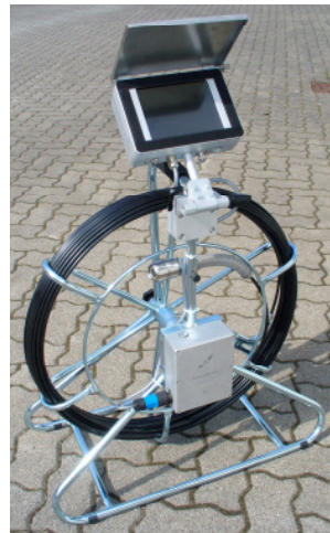
Kamerahaspel 50m mit TFT (IP 65) und automatisch aufrechtem Bild
